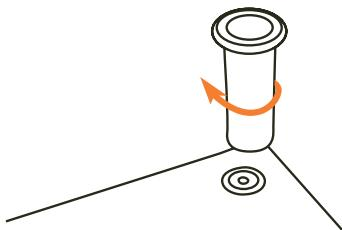
Montieren Sie die Füße. Diese können Sie einfach in die dafür vorgesehenen Öffnungen eindrehen.
